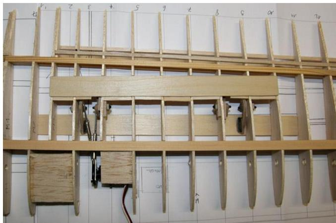
mechanische Kräftekopplung mit ähnlichen Lastverhältnissen. Das eingesetzte Hyperion Servo mit etwa 2,5 kg Stellkraft kommt damit in der Praxis problemlos klar. Das Servo wurde in der Tragfläche liegend direkt vor den Hauptholmen platziert, so konnte eine mechanische Umlenkung wegfallen.
