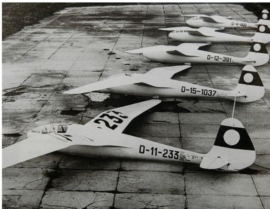
Die für den Reiher optisch charakteristische Kabinenhaube bestand aus 12 Scheiben, die von einem Sperrholzrahmen gehalten wurden. Die Form der Kabinenhaube war ideal in die Rumpfkontur integriert und bot so perfekte aerodynamische Voraussetzungen.
