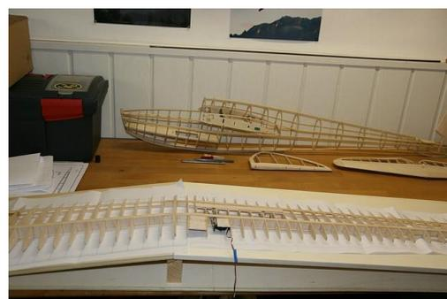
Mit dem Programm Profili Pro des Italieners Stefano Duranti wurden die 3 Teile des Flügels gezeichnet. Da ich über keine Fräse verfüge, wurden die Rippen per Hand ausgeschnitten. Der Bau der Flügel erfolgte dann auf einer Helling.
