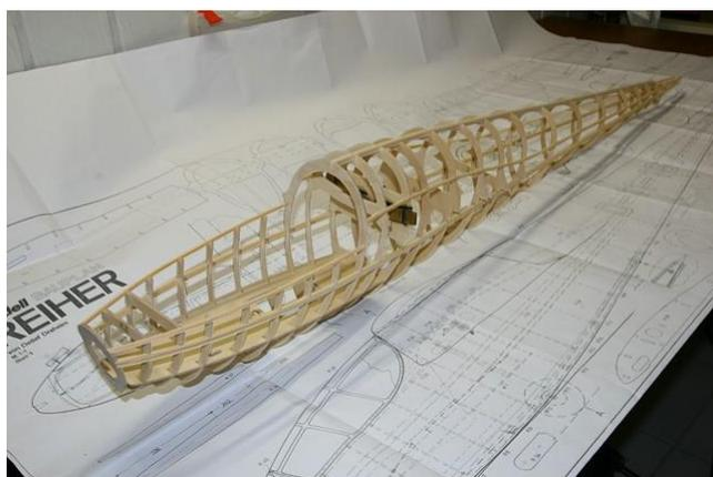
Nicht weniger als 27 Rumpfspanten ergeben zusammen mit verschiedenen Kiefernleisten die unverwechselbare Rumpfform, die bei geringem Gewicht sehr stabil ist. Das abnehmbare Höhenleitwerk ist wie das Seitenleitwerk teilbeplankt. Der Rumpf wurde mit 2mm Balsa beplankt und
